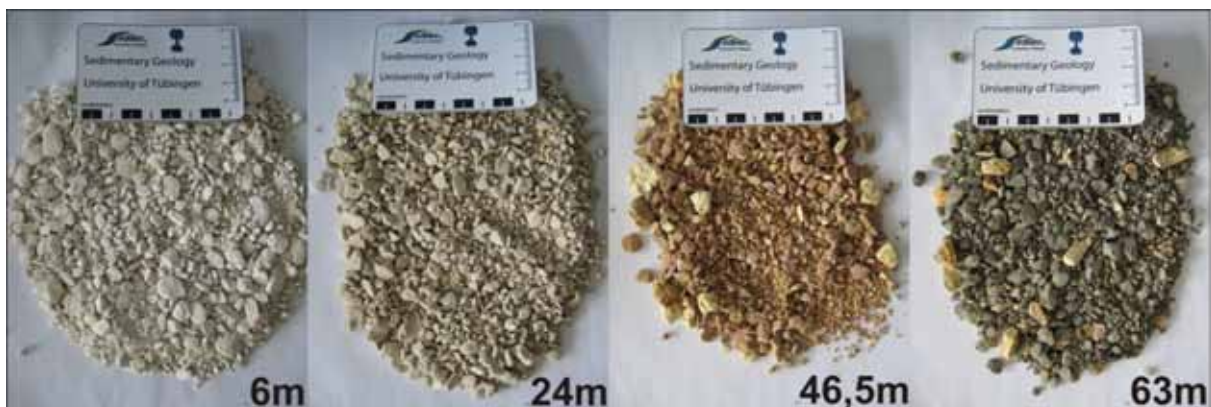
Abb. 3: Gefördertes Bohrklein (Cuttings) aus unterschiedlichen Tiefen. Die unterschiedliche Graufärbung ist ein Maß für den Tongehalt. Aufn.: MARTIN BARTENBACH.
